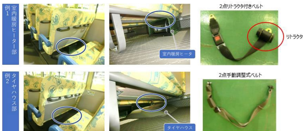
幼児用の2点式リトラクタ付座席ベルトを備えられない場所の例
